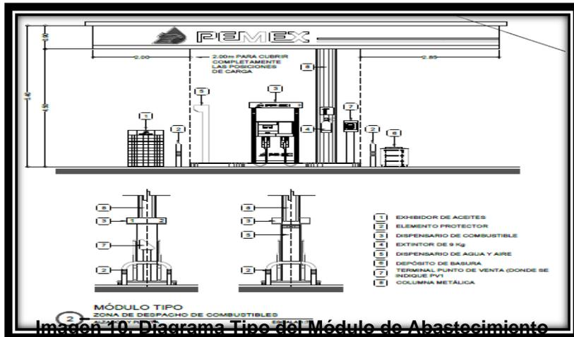
Imagen 10. Diagrama Tipo del Módulo de Abastecimiento
