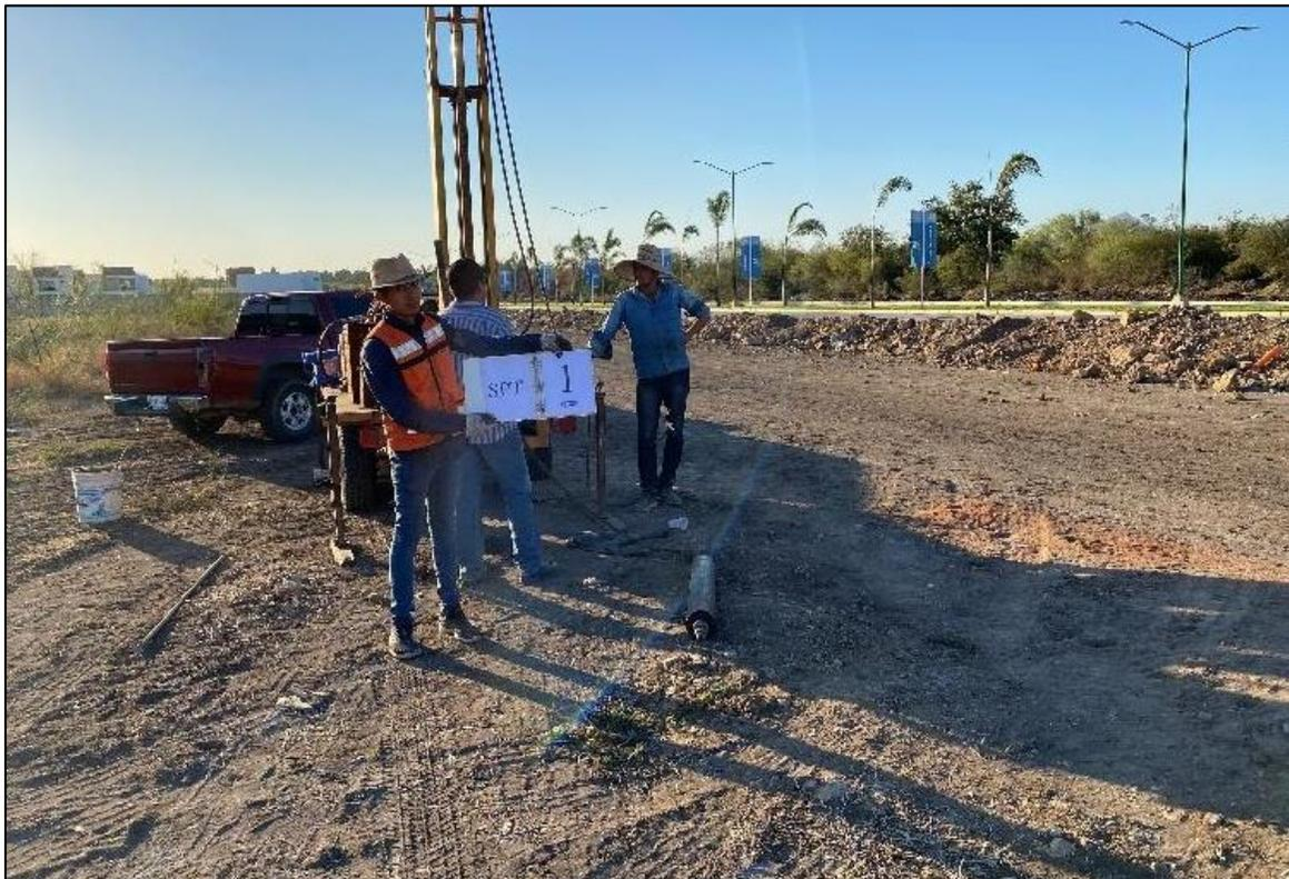
Fotografía 6. Vista de la realización del Sondeo de Penetración Estándar (SPT 1).
