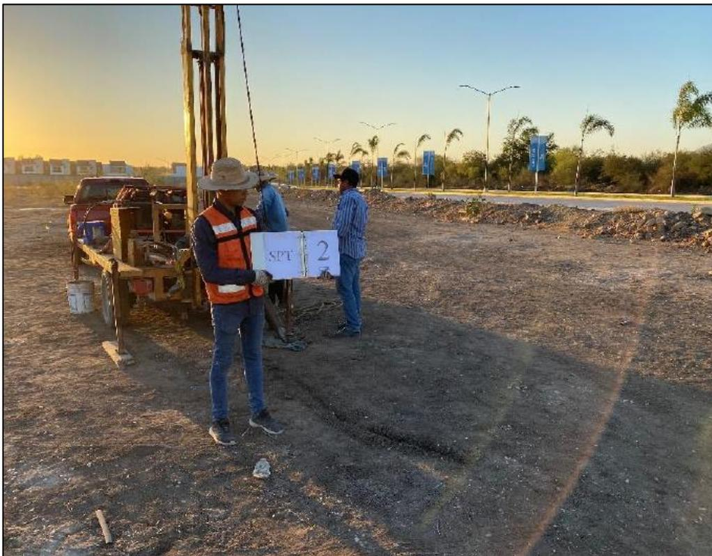
Fotografía 8. Vista de la realización del Sondeo de Penetración Estándar 2 (SPT 2).
