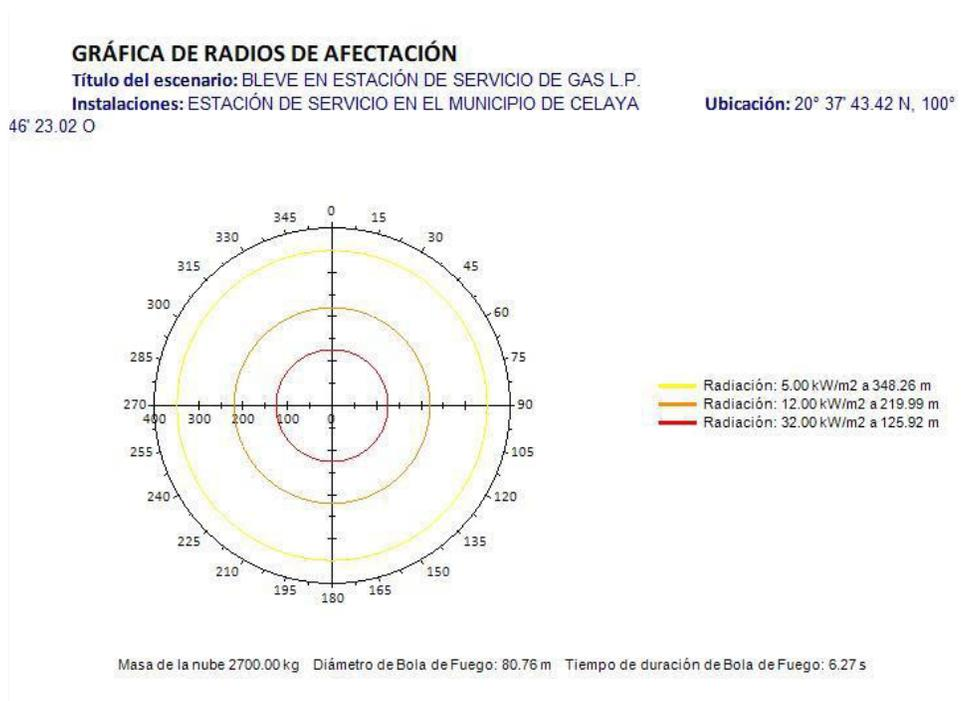
Figura 11. Gráfica de radios de afectación en caso de una “Fireball” con un diámetro de 80.76 m y duración de 6.7 s
