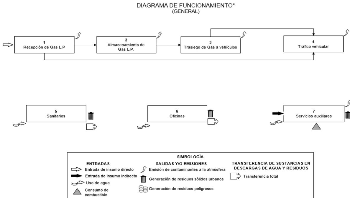
Gráfico 3 Diagrama de funcionamiento general de la Estación
