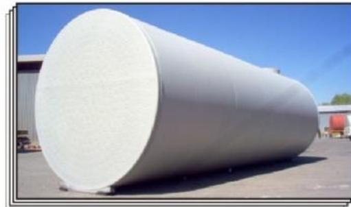
Tanque cilíndrico horizontal doble pared acero-fibra de vidrio, ecológico para almacenamiento de combustible, fabricado bajo las normas UL-58, UL-1746 y especificaciones PEMEX.
