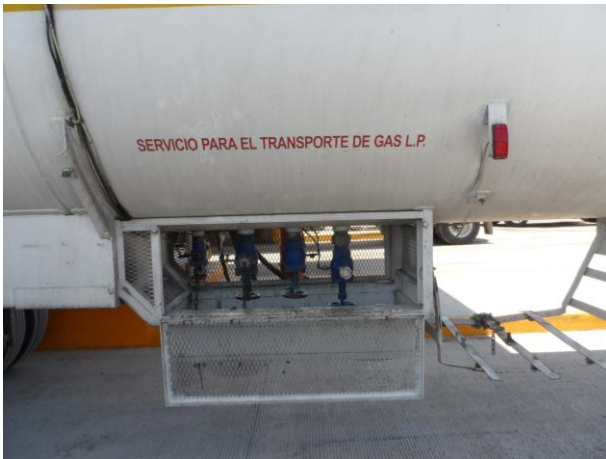
Figura 67. Válvulas de carga y descarga ubicadas en la parte inferior de semirremolques
