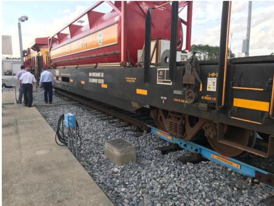
Figura II. 4 Ejemplo Instalación en USA.- Riel Pesador modelo WEIGHLINE (Riel en color azul)
