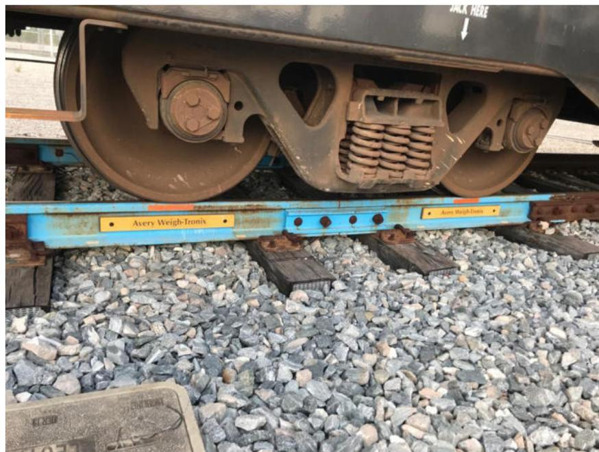
Figura II. 5 Ejemplo Instalación en USA.- Riel Pesador Avery Weigh-Tronix modelo WEIGHLINE (Riel en color azul)
