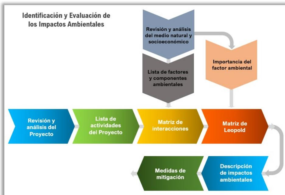
Ilustración 67. Diagrama de flujo del proceso de identificación y evaluación de impactos ambientales.
