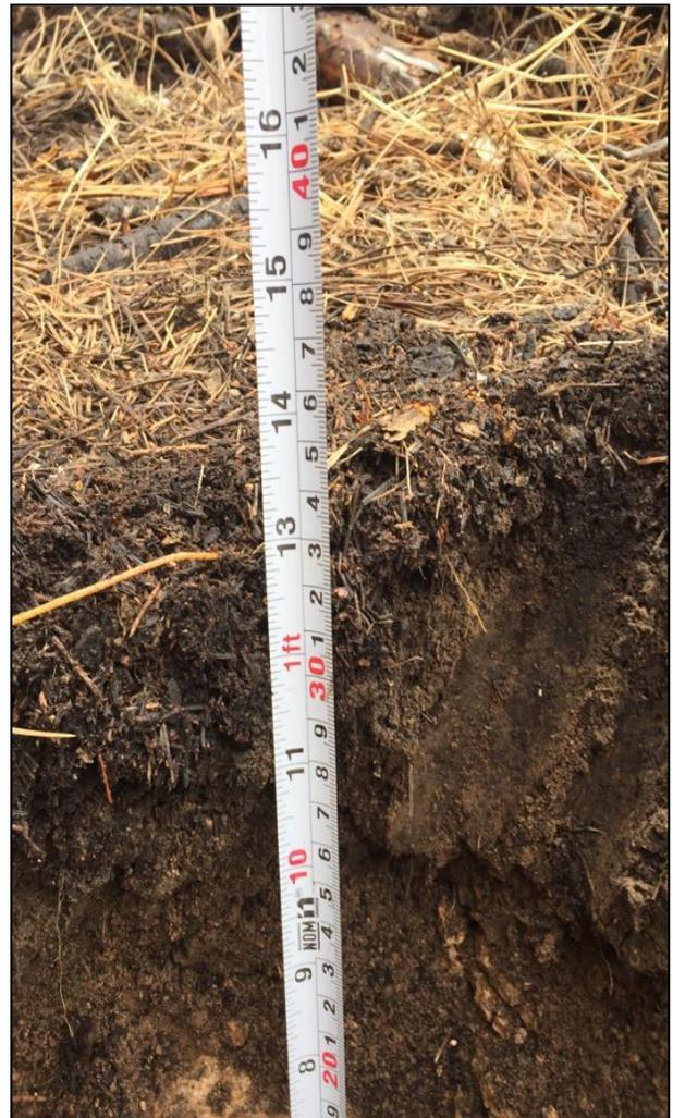
11. Con ayuda de flexómetro se comprobó la infiltración del hidrocarburo en el sitio en estudio, el cual presenta textura limosa.
