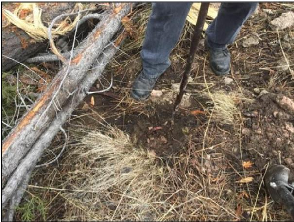
09. Se realizaron sondeos en distintas partes del área afectada a fin de determinar la pluma del contaminante.
