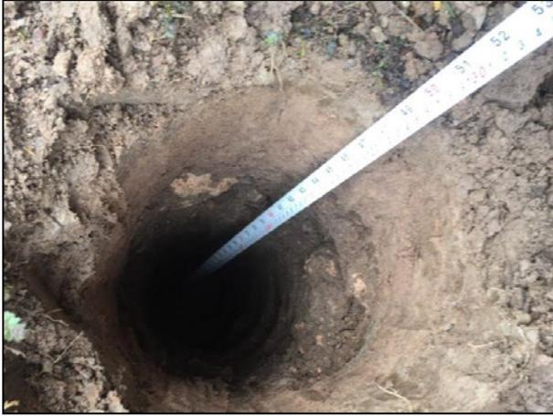
07. Con apoyo de flexómetro se verificaron las profundidades de los pozos de sondeo para conocer la pluma del contaminante.
