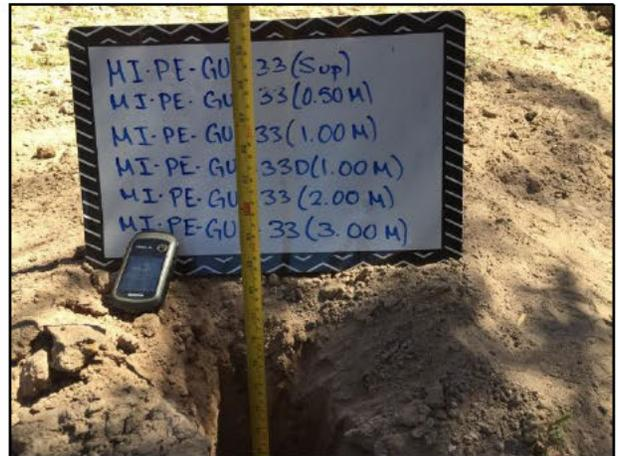
16. La profundidad de los puntos de muestreo fueron verificadas con apoyo de un flexómetro.
