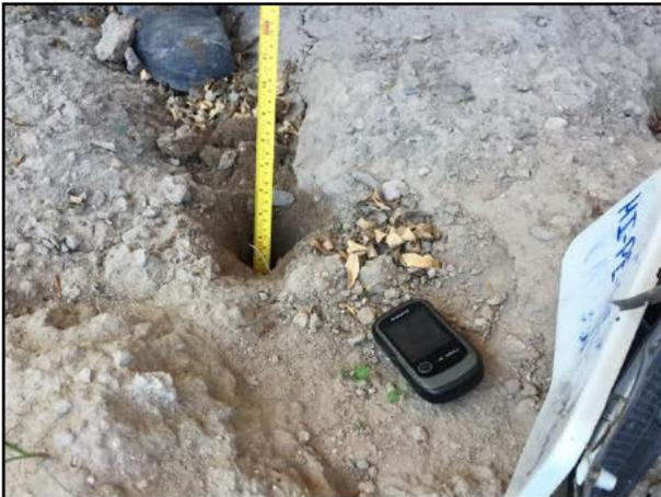
09. Las profundidades de los puntos de muestreo fueron verificadas con apoyo del flexómetro.
