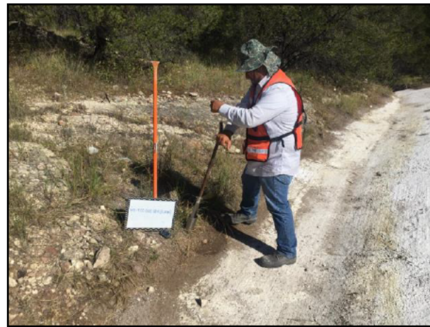
06 - Con el apoyo de Hand Auger de acero inoxidable, se realizaron las tomas de muestras de profundidad. Toma de muestra en fondo de la Zona de Extracción A.
