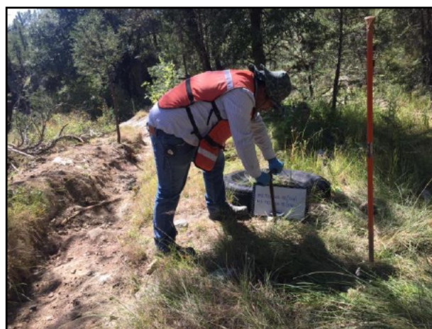
10 - Se llevaron a cabo tomas de muestras en las periferias de las Zonas de Extracción. Toma de muestra a profundidad en la periferia de la Zona de Extracción D.
