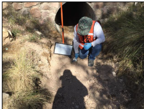
08 - Con apoyo del cucharón de acero inoxidable se realizó la toma de muestras superficiales.
