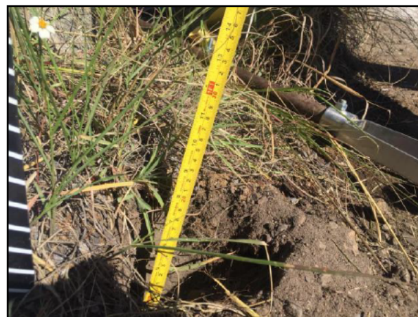
04 - Las profundidades de los puntos de muestreo fueron verificadas con apoyo de flexómetro.
