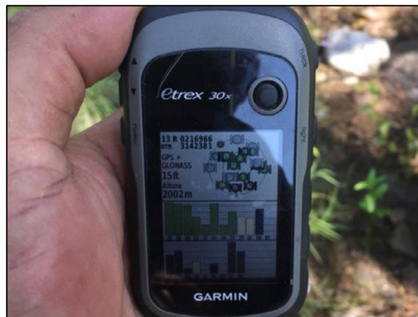
06 - Por medio de GPS se determinaron las coordenadas UTM de los puntos de sondeo, además de los vértices de las Zonas afectadas.
