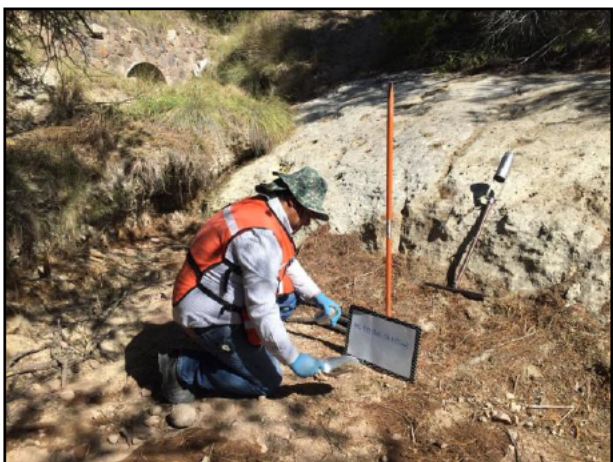
05 - Se realizaron tomas de muestras en fondo de acuerdo con el Plan de Muestreo. Toma de muestra en el fondo de la Zona de Extracción C.
