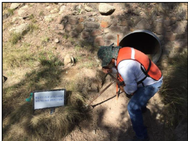
07 - De acuerdo con el Plan de Muestreo, se realizaron tomas de muestras en paredes a distintas profundidades. Toma de muestra en pared en la Zona de Extracción B.
