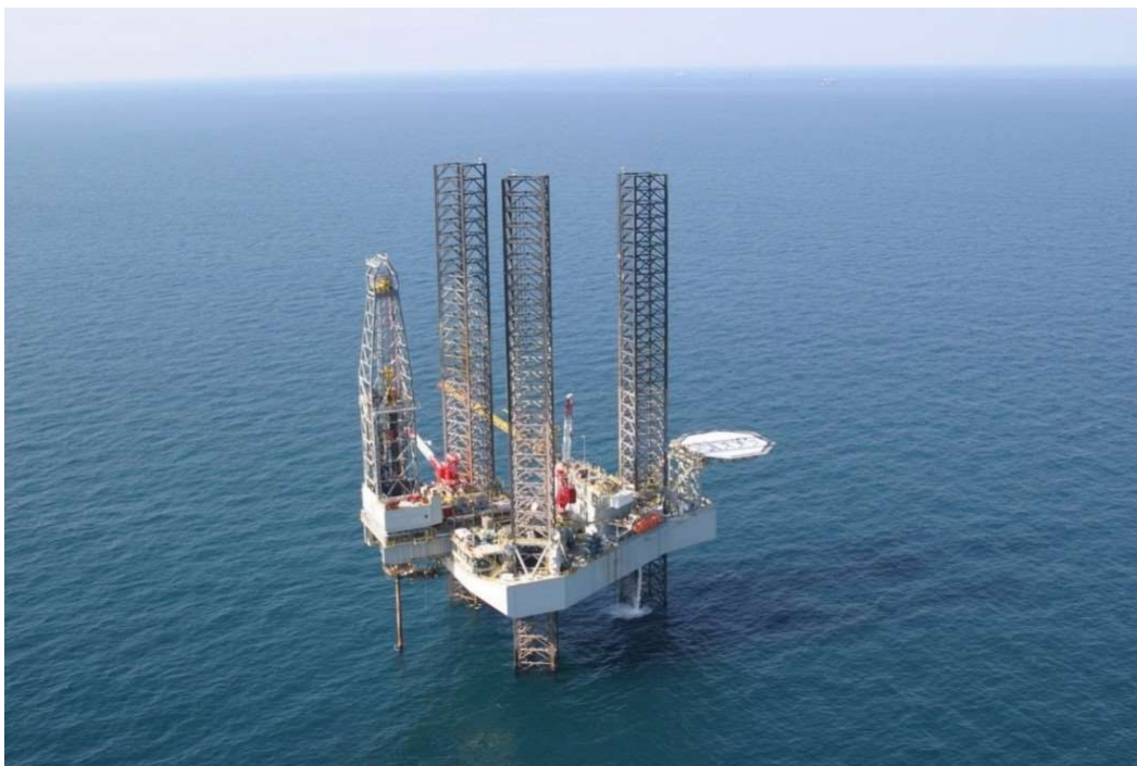
Imagen RE 1. Ejemplo de una plataforma auto elevable tipo Jack-up: Maersk Resilient
