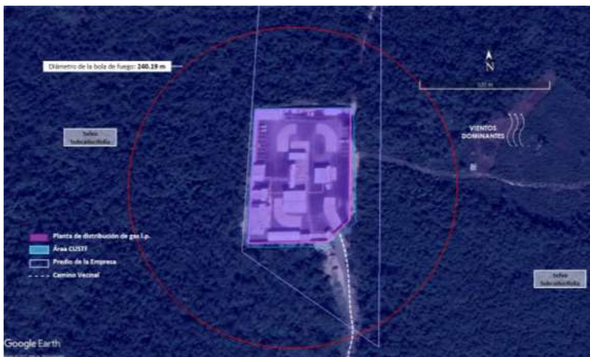
Figura II.9. Máximo diámetro de la Bola de Fuego originada por la BLEVE de un tanque de almacenamiento de gas l.p. con capacidad de 150,000 m 3
