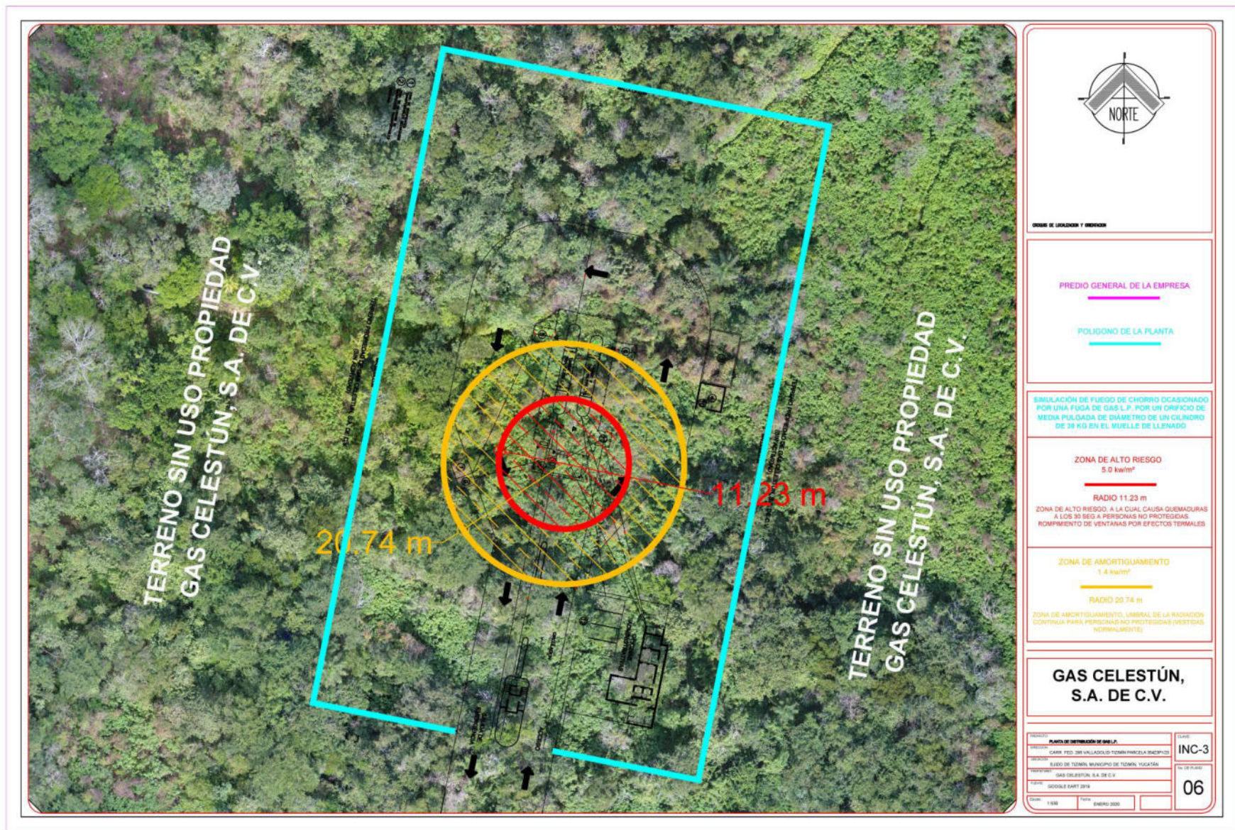
Figura 58. Simulación de fuego de chorro ocasionado por una fuga de gas L.P. por un orificio de media pulgada de diámetro de un cilindro de 30 kg en el muelle de llenado.
