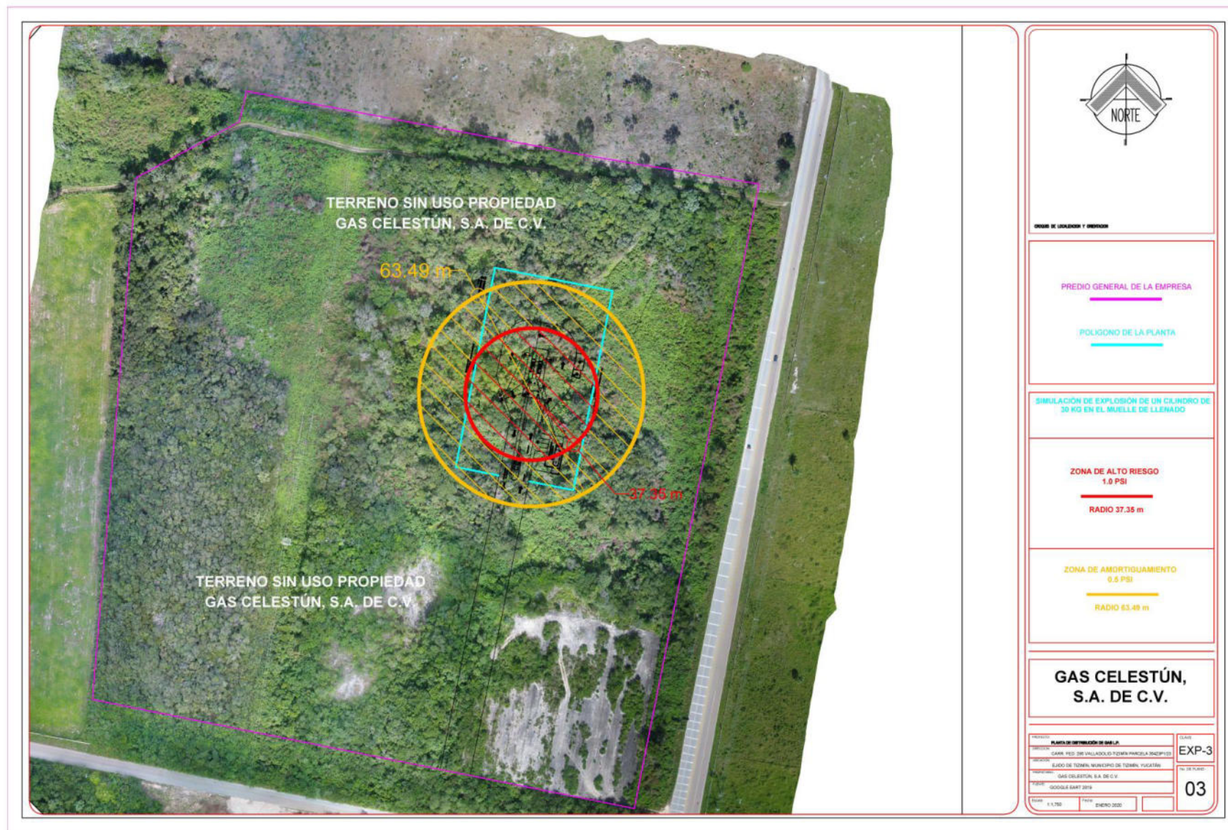
Figura 55. Simulación de la explosión de un cilindro de 30 kg en el muelle de llenado.
