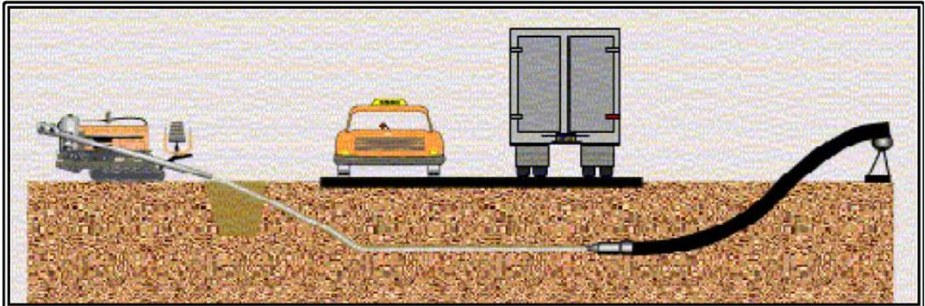
Figura II. 6 Imagen que muestra la forma de excavación de una perforadora direccional para el cruce subterráneo sin afectar la infraestructura vial.
