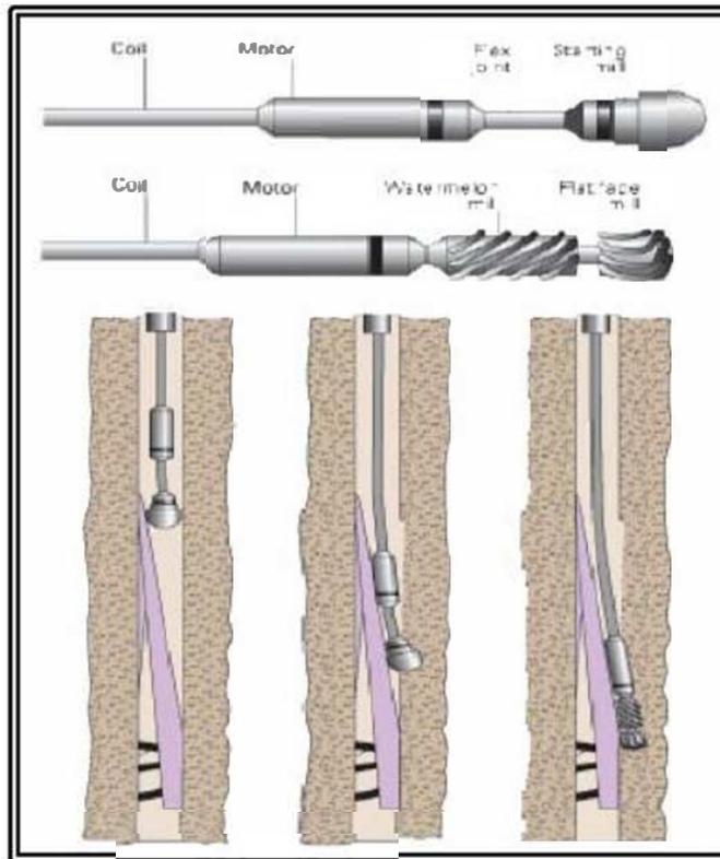
Figura II. 5 Ejemplos de diferentes puntas de perforación.
