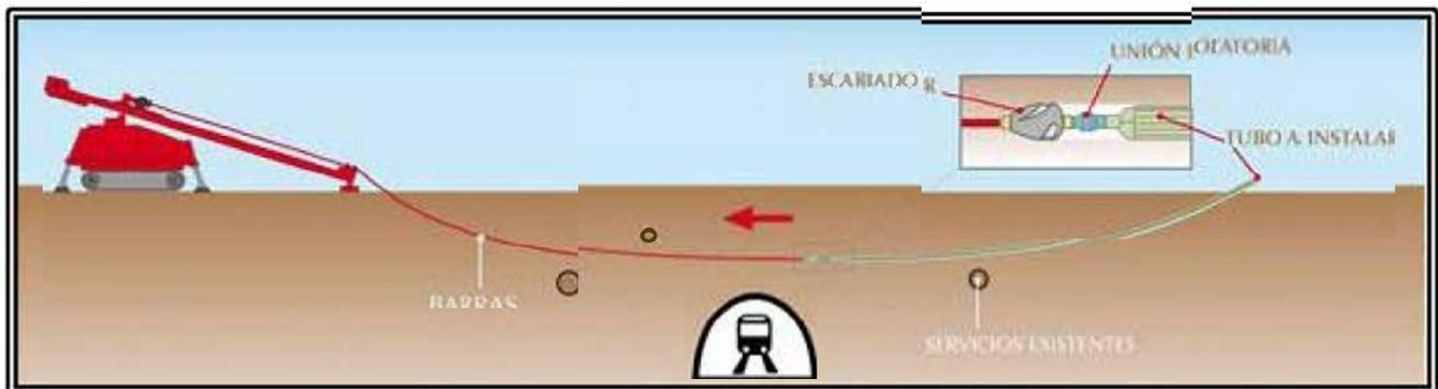
Figura II. 7 Detalle de la forma de trabajo de una perforadora direccional que respeta las instalaciones conocidas de un sitio al dirigirla en su excavación, evitando cualquier afectación.
