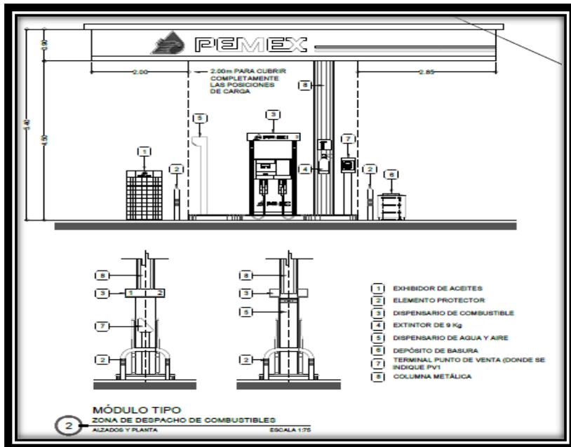
Imagen 10. Diagrama Tipo del Módulo de Abastecimiento
