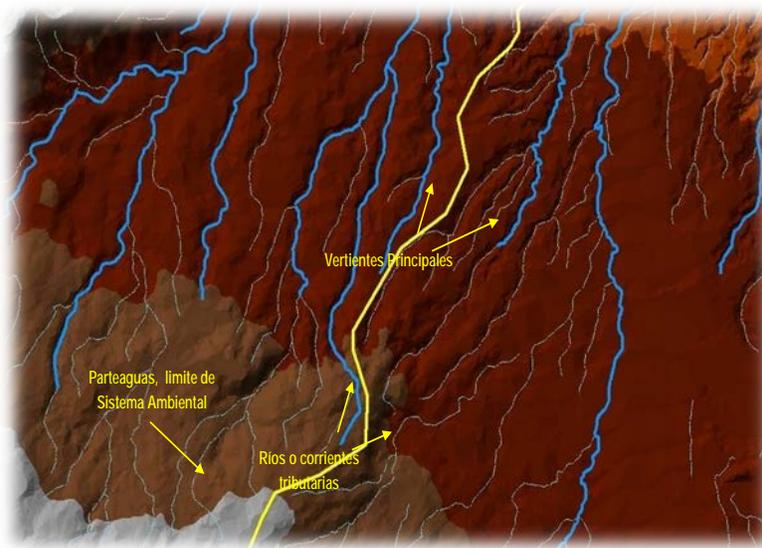
La obtención del Sistema Ambiental se llevó a cabo mediante la determinación de la microcuenca mediante SIGEIA que después fue convertida a archivo SHP mediante el software ArcMap 10.2.2
