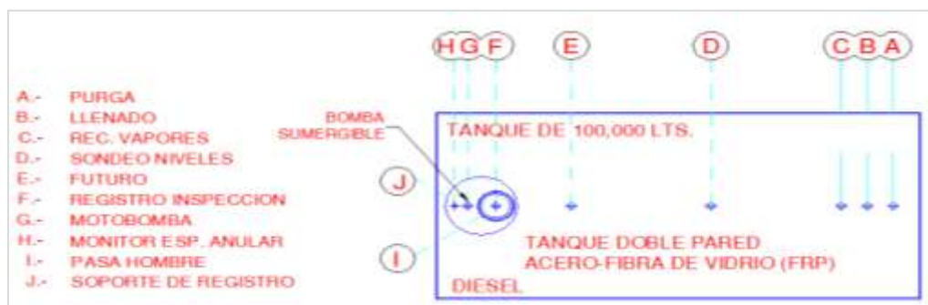
Figura 14. Elementos del tanque de almacenamiento
