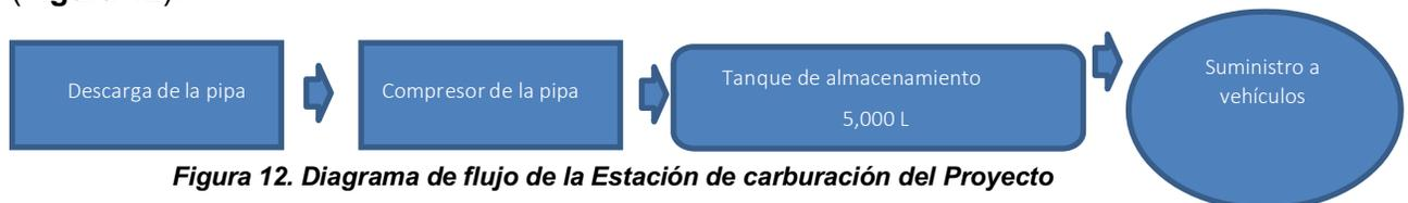
Figura 12. Diagrama de flujo de la Estación de carburación del Proyecto
