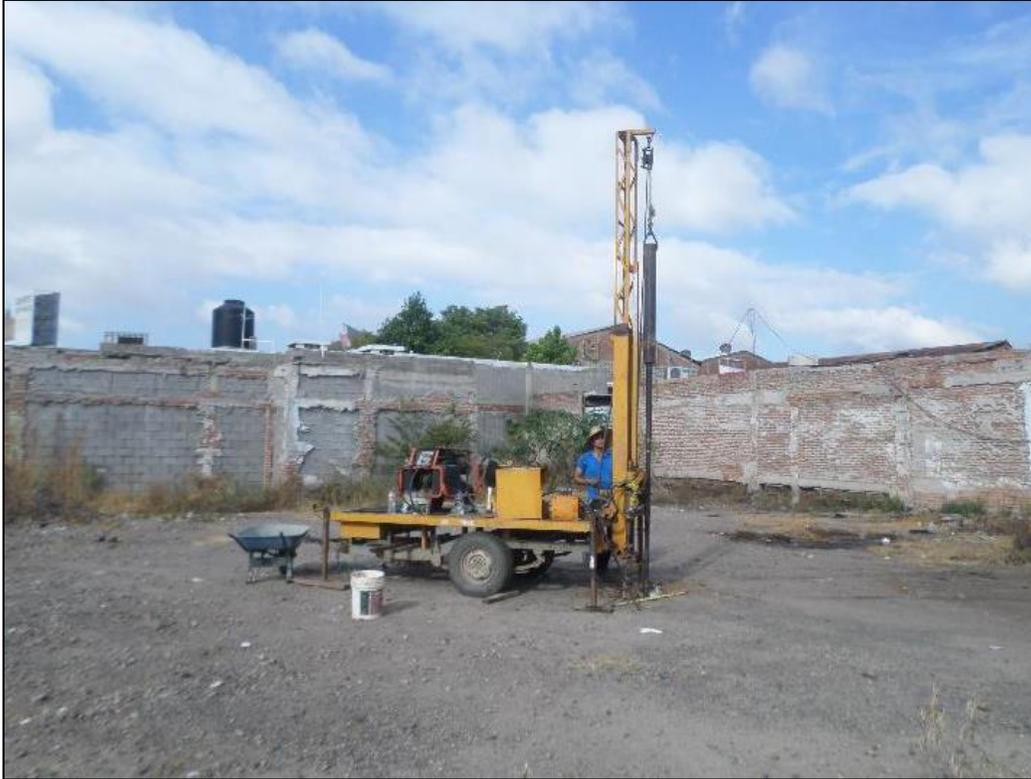
Fotografía 4. Vista de la realización del Sondeo de Penetración Estándar (SPT 1).
