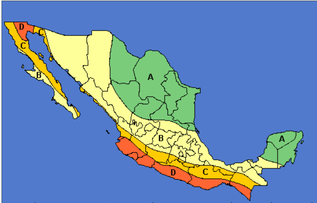
Figura 12. Regionalización Sísmica de la República Mexicana. http://www.ssn.unam.mx/website/html/SSN/Sismos/region_sismica_mx.html
