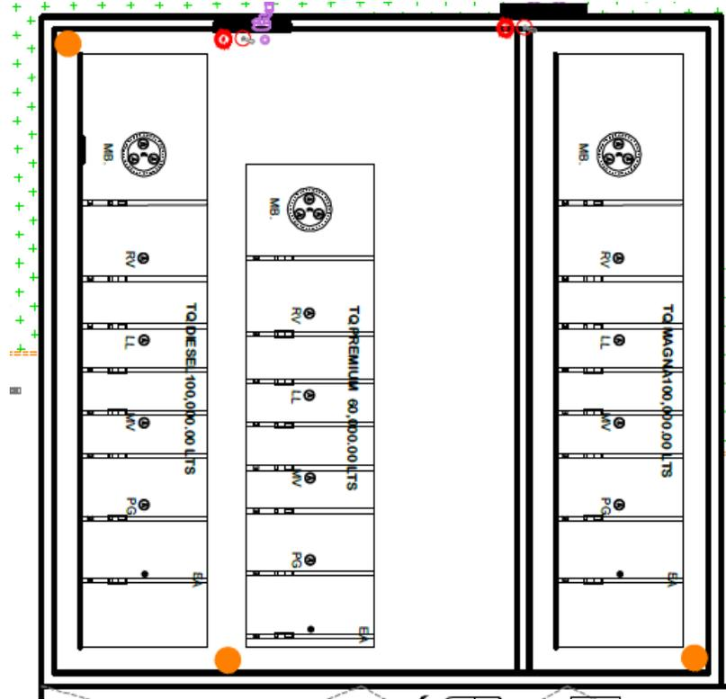
Figura 8. Tanques de almacenamiento de Gasolina Magna, Gasolina Premium y Diésel
