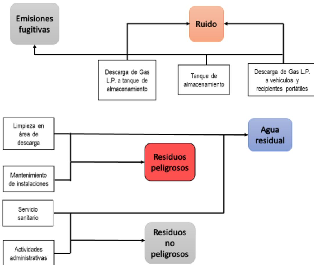
Figura 7. Diagramas de flujo de emisiones, descargas y residuos durante la operación de la estación de carburación.
