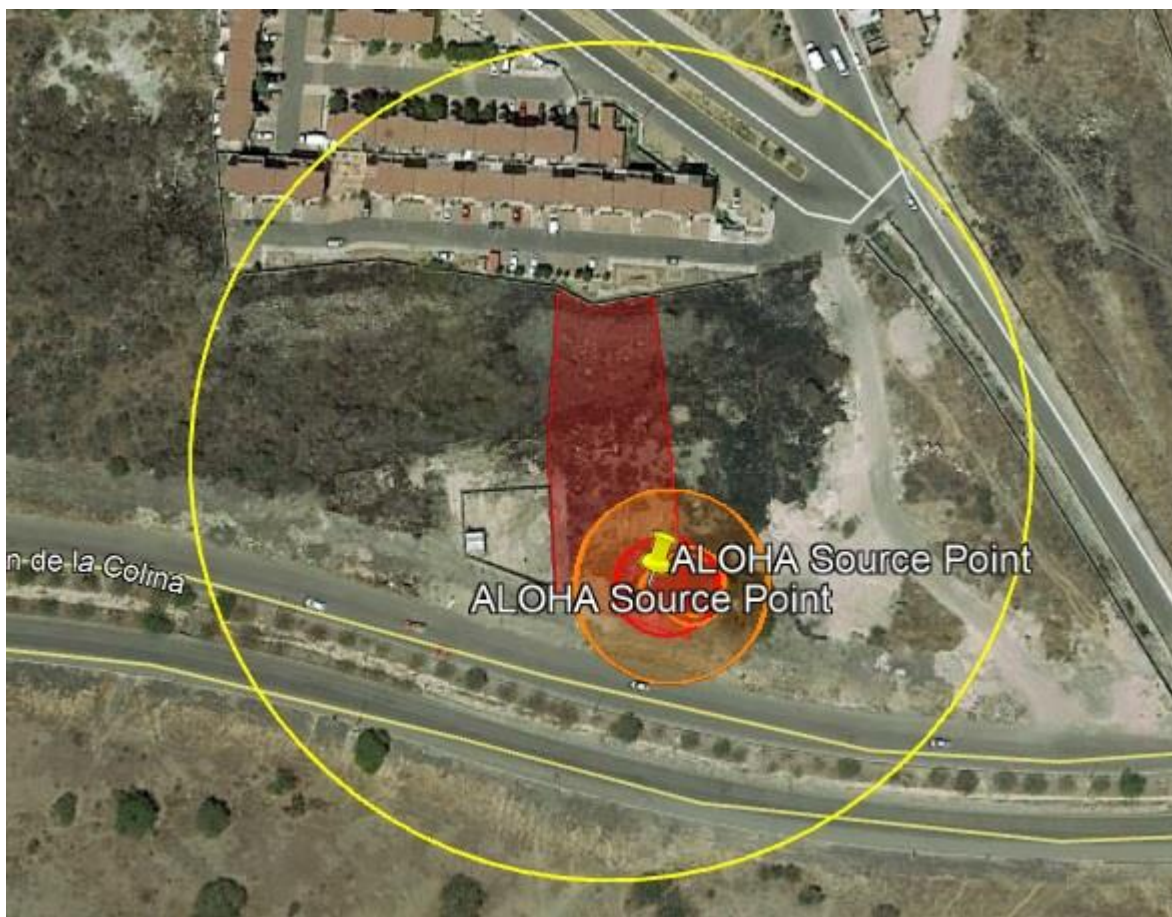
IMAGEN 22.- Superficie de incidencia y afectación por escenario de explosión e incendio en el tanque de almacenamiento de gasolina.
