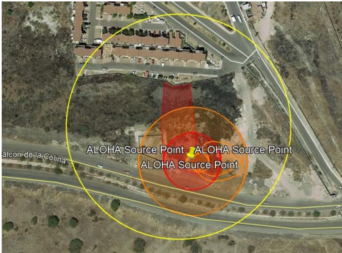
IMAGEN 21.- Superficies de incidencia y afectación de los escenarios de explosión e incendio por la descarga de gasolina del auto-tanque a los tanques de almacenamiento.
