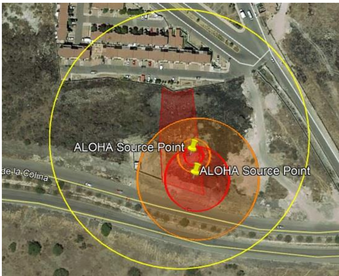
IMAGEN 23.- Superficie de incidencia y afectación por escenario de incendio en los dispensarios de gasolina y Diésel.
