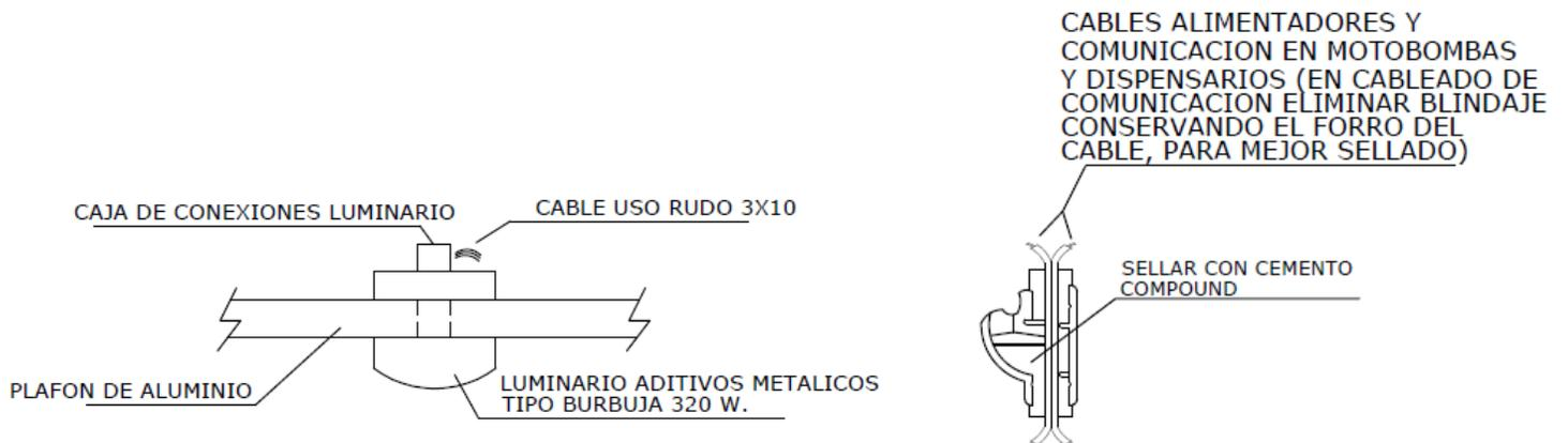
Figura 13. Detalle de salida para luminario aditivo metálico y detalle de corte sello tipo "EYS"
