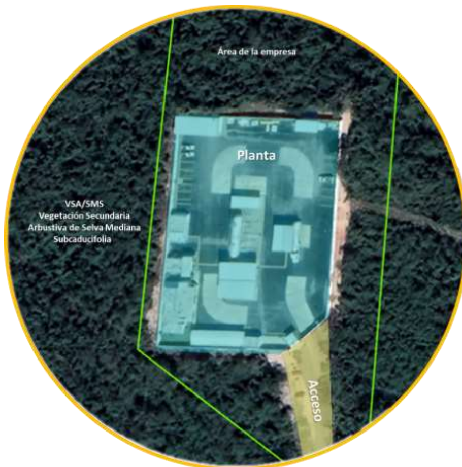
Figura II.8. Radio de seguridad de 100m de los tanques de acuerdo a la NOM-001-SESH -2014.
