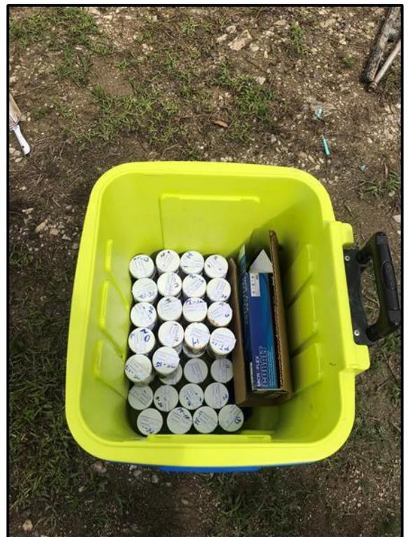
DISPOSICIÓN DE LAS MUESTRAS DE SUELO EN UNA HIELERA PARA MANTENERLAS A BAJA TEMPERATURA HASTA SU ENTREGA.
