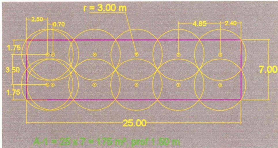
Figura 1a.- Vista de planta, distribución de los pozos para airear el área impactada A1.
