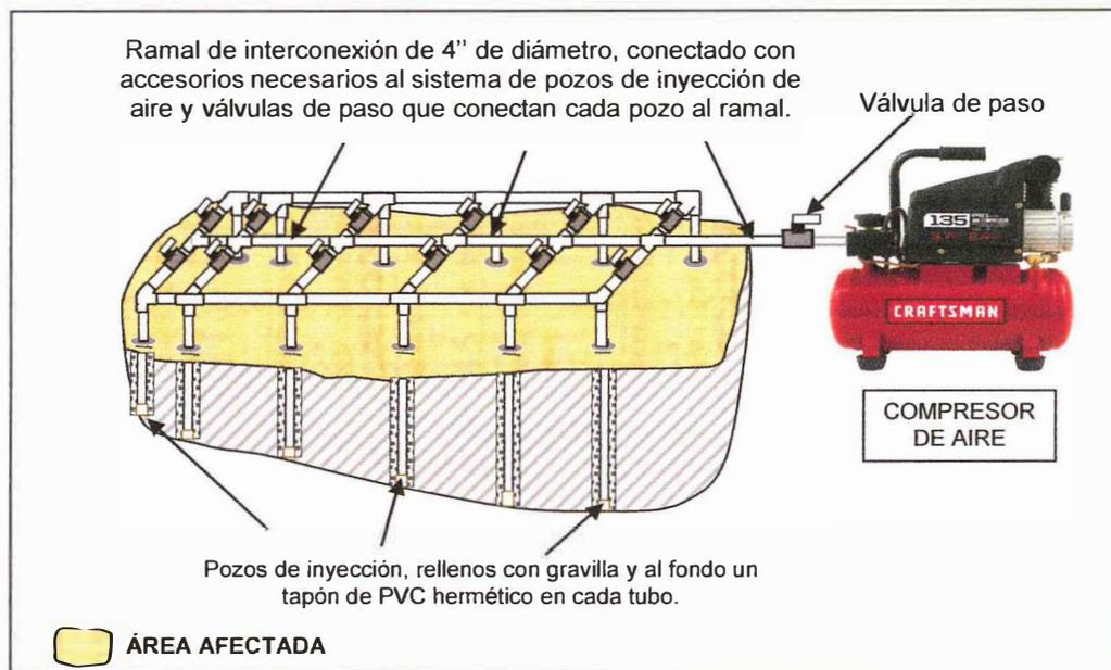
Figura 3.- Red de inyección de aire y ramal de interconexión (ilustrativo).
