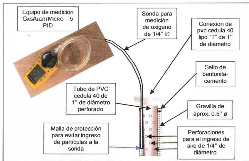
Figura 6.- Determinación de oxígeno en el proceso de tratamiento.
