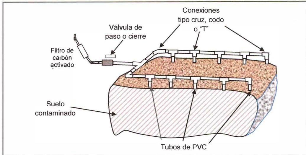
Figura 5.- Diagrama esquemático del filtro de carbón activado (ilustrativo).
