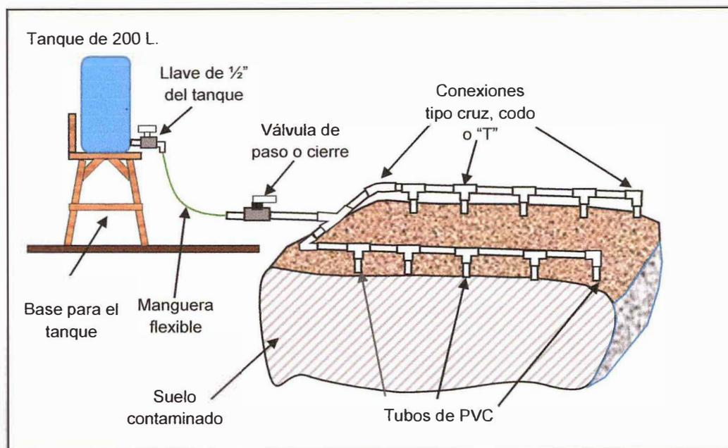
Figura 4.- Diagrama esquemático de infiltración de insumos (ilustrativo).
