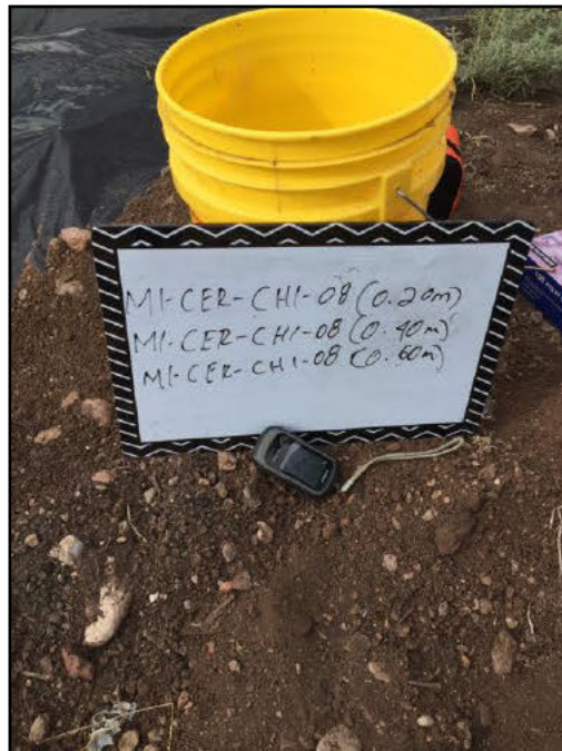
10. Las coordenadas de los puntos de muestreo fueron tomadas con apoyo de un GPS, tomando como guía el pla de muestreo.
