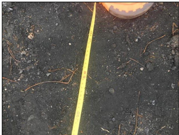
7. Con apoyo de cinta métrica, se midieron los pozos de sondeo para conocer la profundidad de infiltración de la Gasolina y Diésel derramados.
