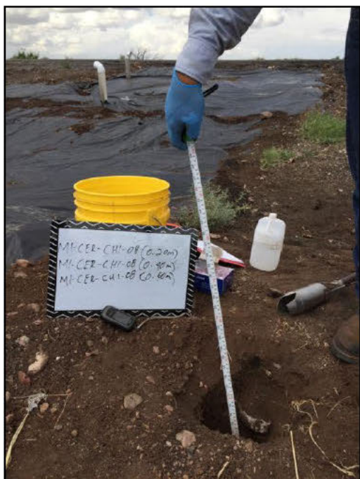
11. Verificación de diferentes profundidades en los puntos de muestreo.
