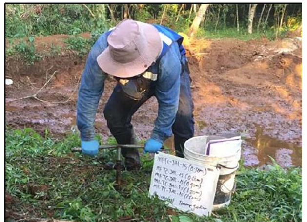
12. Se recolectaron muestras a diferentes profundidades en los diferentes puntos de muestreo.
