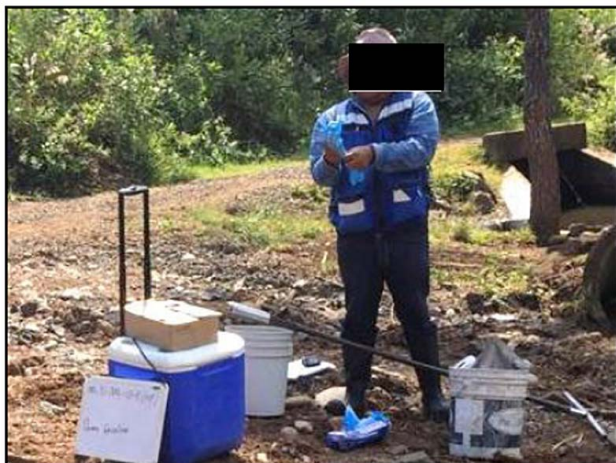
01. Se utilizaron guantes de nitrilo al inicio y entre cada toma de muestras para evitar la contaminación cruzada de las mismas.
