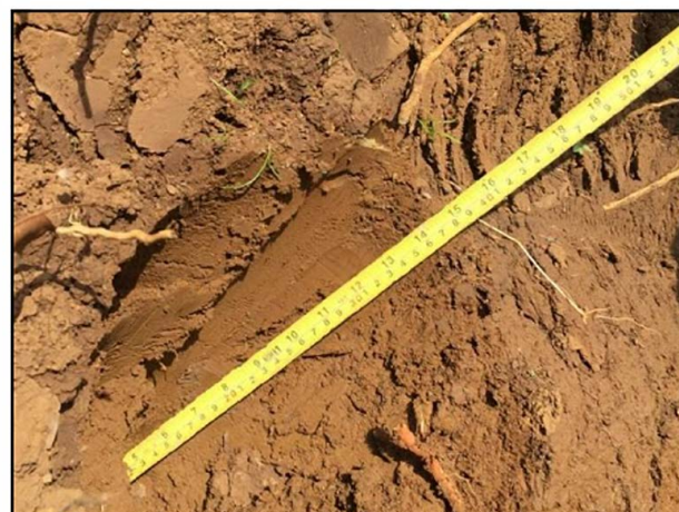
04. Las profundidades de los puntos de muestreo fueron verificadas con apoyo del flexómetro.
