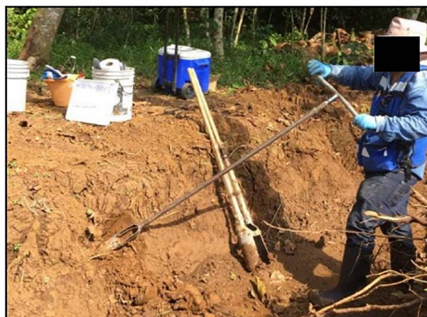
05. Con apoyo de Hand Auger de acero inoxidable se tomaron muestras en las paredes de la fosa de excavación.
