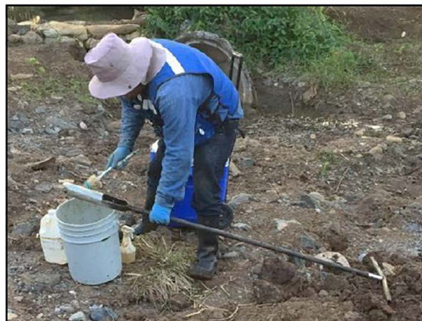
14. Se hizo el lavado del equipo de muestreo entre cada toma de muestras para evitar la contaminación cruzada.
