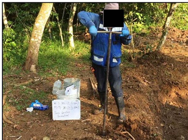
11. Se realizó la toma de muestras en la periferia de la fosa de excavación.
