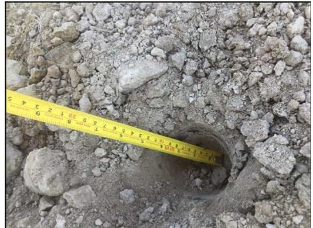
4. Las profundidades de los puntos de muestreo fueron verificadas con apoyo de flexómetro.
