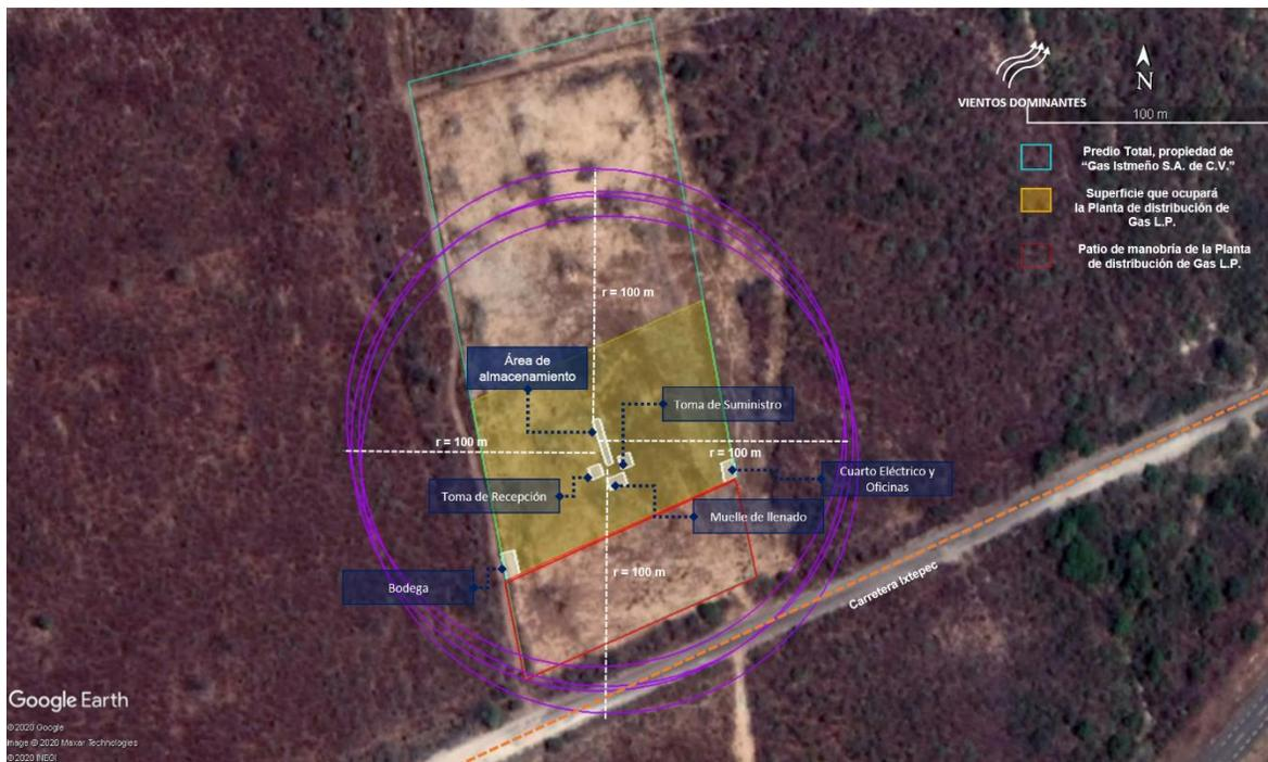
**Figura II.8.** Ubicación de la planta de distribución de GLP y alrededores dentro de radios de 100 m medidos desde la tangente del tanque de almacenamiento.
