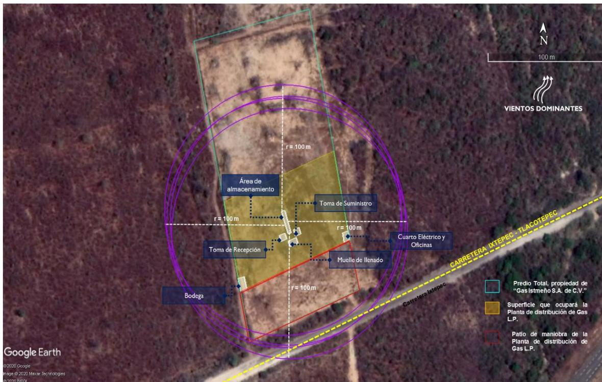
**Figura.I.1.** Ubicación de la planta de distribución de GLP y alrededores dentro de radios de 100 m medidos desde la tangente del tanque de almacenamiento.
