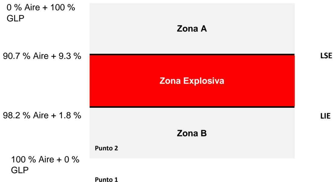
**Punto 1** = 20 % del LIE: Valor de ajuste de las alarmas en los detectores de mezclas explosivas.
