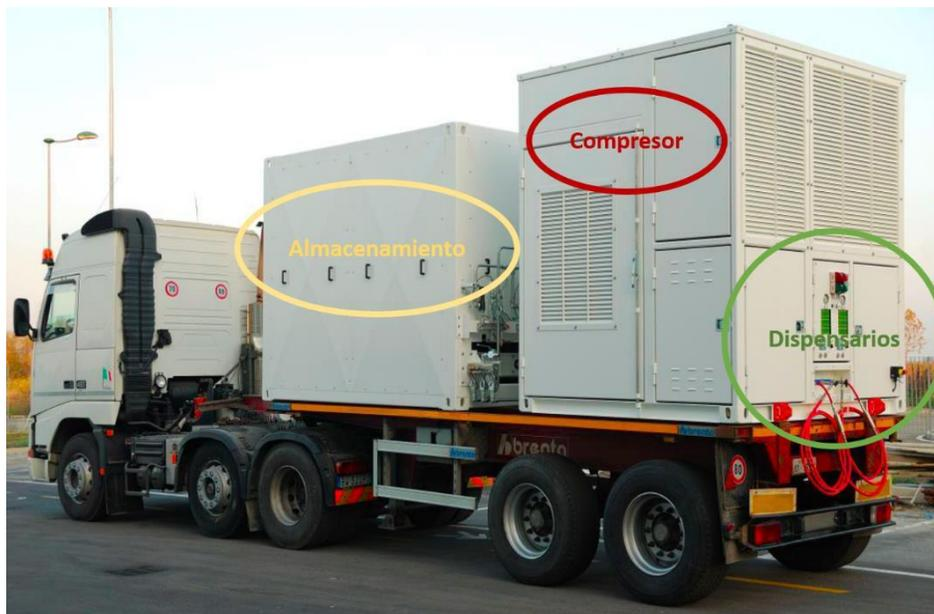
**Figura 9. Equipos que conforman la UMD.**
