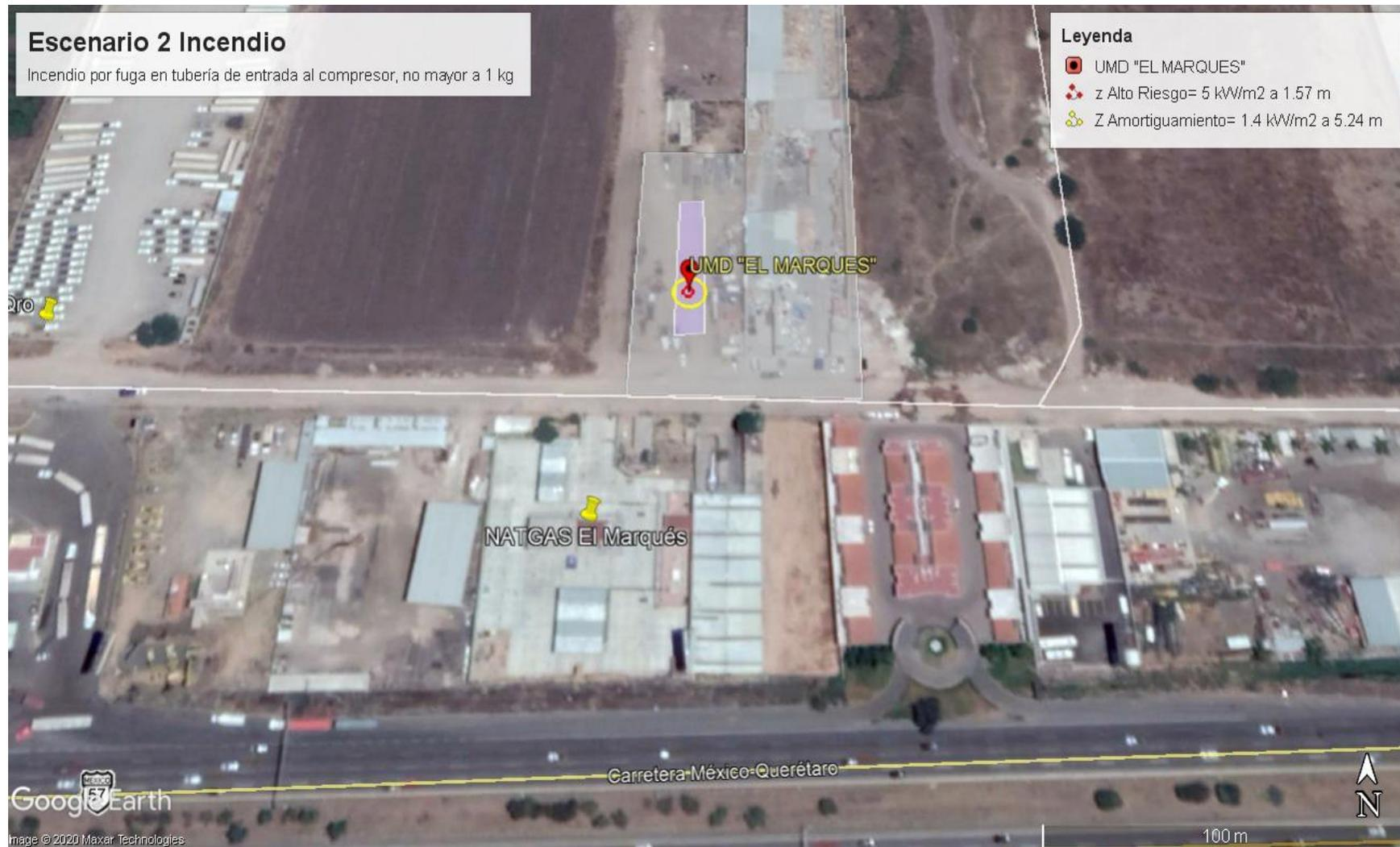
**Figura 34. Radios de Afectación por Radiación Térmica para el Escenario 2 Incendio por fuga en tubería de entrada al compresor, no mayor a 1 kg. Más probable, menos catastrófico.**
