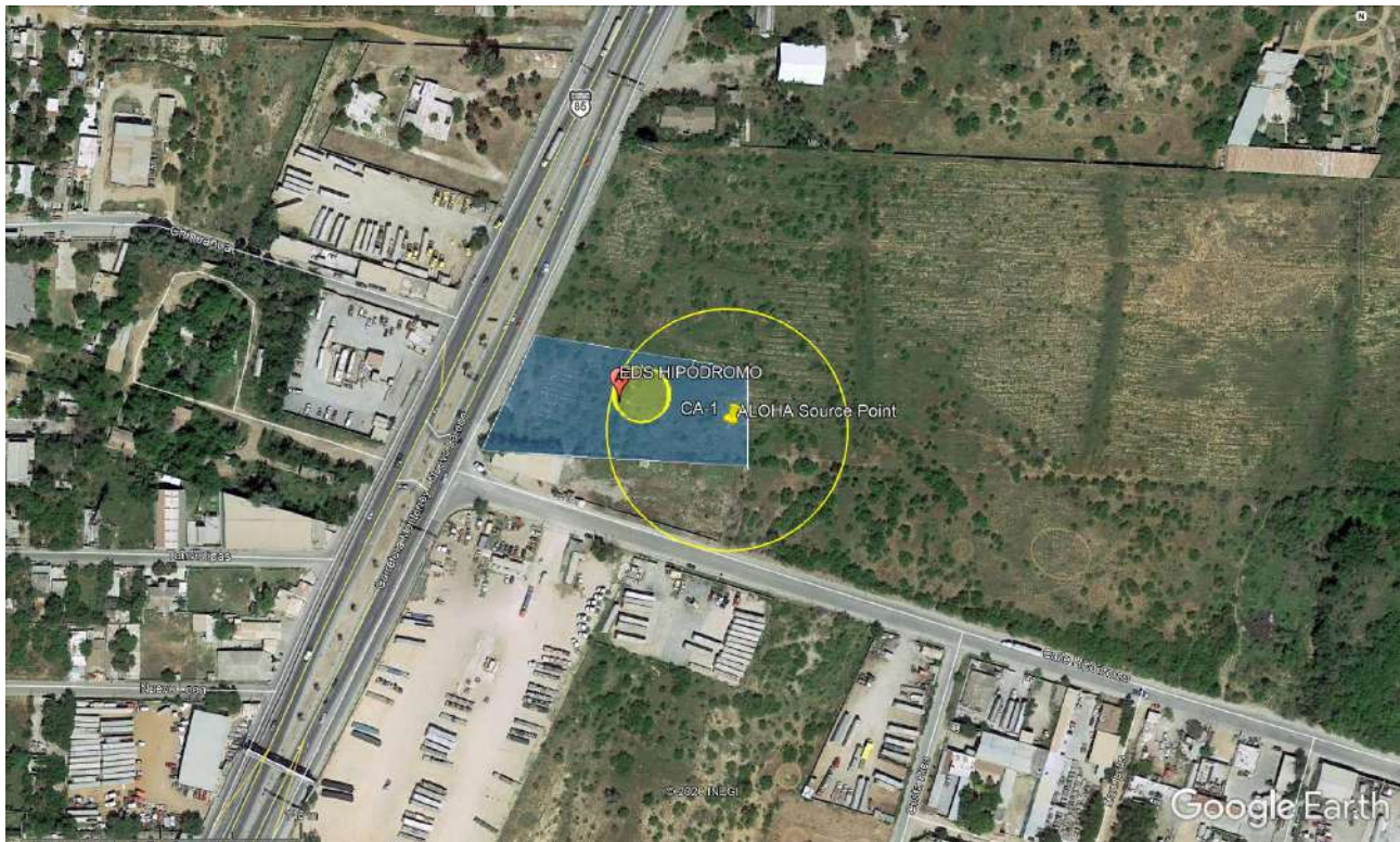
Figura II.48 Radios de explosión para una fuga 25mm de gas natural en la cascada pulmón 1 - Cilindro (2,370 Litros)
