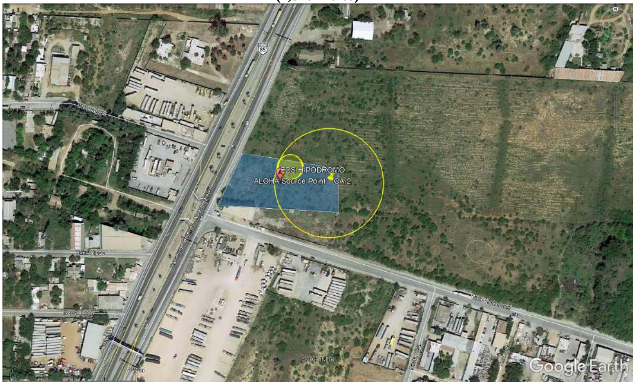
Figura II.49 Radios de explosión para una fuga 25mm de gas natural en la cascada pulmón 2 - Cilindro (2,370 Litros)
