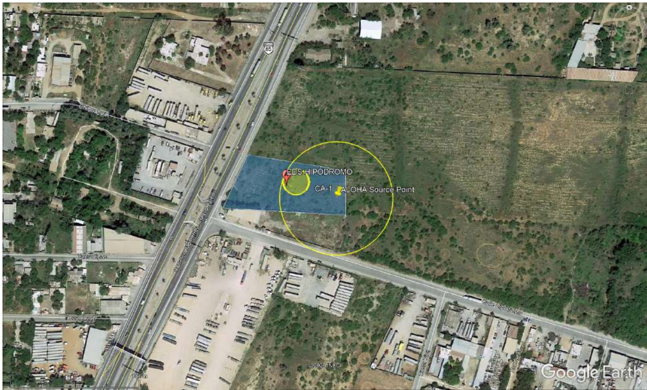
Figura II.42 Radios de explosión para una fuga 100mm de gas natural en la cascada pulmón 1 - Cilindro (2,370 Litros)
