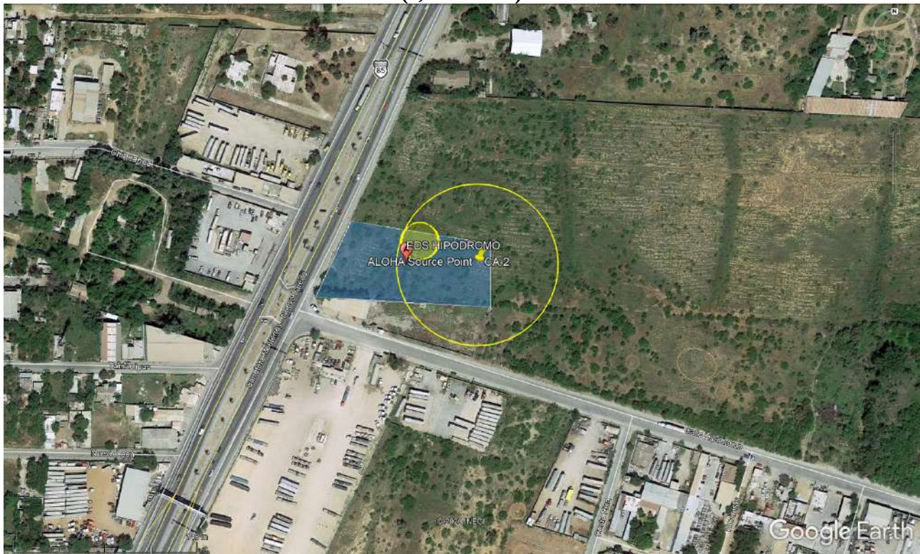
Figura II.43 Radios de explosión para una fuga 100mm de gas natural en la cascada pulmón 2 - Cilindro (2,370 Litros)
