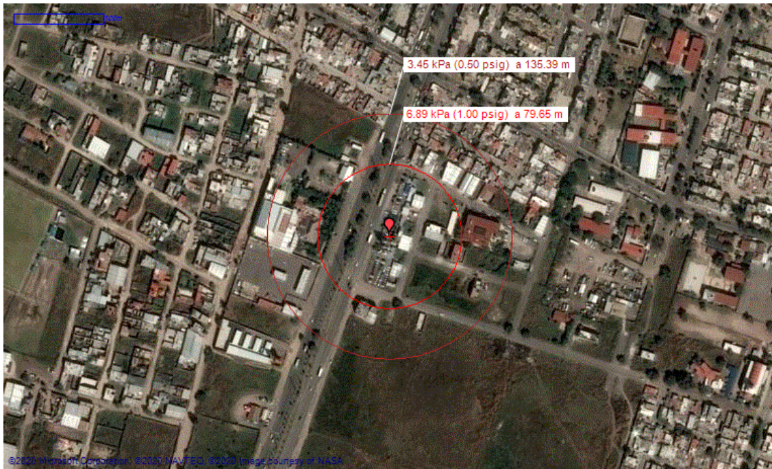
Ilustración 32. Radios de afectación del escenario, sobrepresión al 100%
