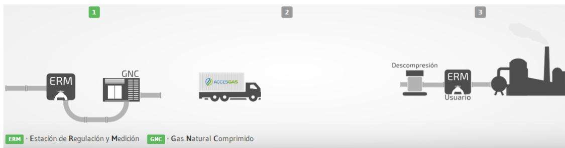
FIGURA 1. PROCESO DE FUNCIONAMIENTO DE UN GASODUCTO VIRTUAL.
