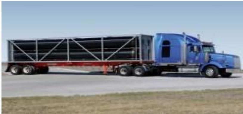
El peso más bajo debido al diseño único de gran tamaño del tanque, lo cual permite transportar grandes volúmenes de gas natural comprimido.
