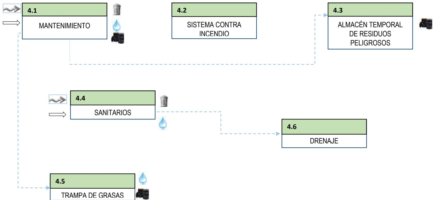
IMAGEN 4. Diagrama de funcionamiento general y de servicios auxiliares de la estación de servicio.
