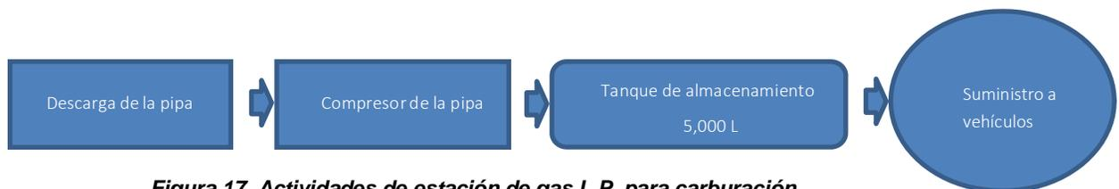
*Figura 17. Actividades de estación de gas L.P. para carburación.*
