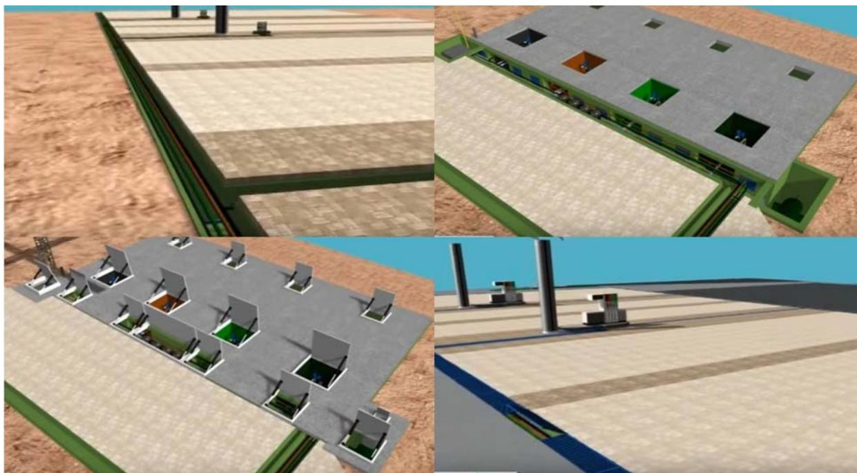
**Fig. 6** *Proceso de terminado en la instalación de los tanques de almacenamiento y sistema de despacho de combustible en la estación (arriba de izquierda a derecha); se colocaron canaletas y tuberías desde los tanques hasta las bombas de despacho. Los tanques están cubiertos con una capa de hormigón para posteriormente poner las cubiertas y sistemas de seguridad para finalmente hacer las conexiones con las bombas de combustible.*
