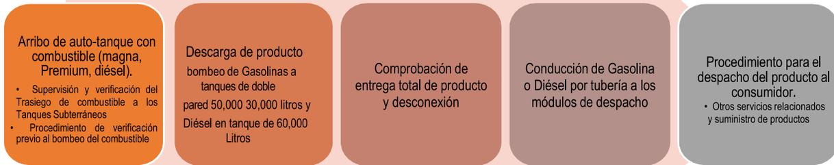
**Figura 18. Diagrama de flujo genérico de combustible**
