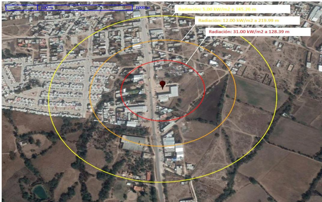
Figura 8. Radios de afectación en caso de la rotura del recipiente por encima de o igual a la presión de la válvula de alivio en la Estación de Servicio
