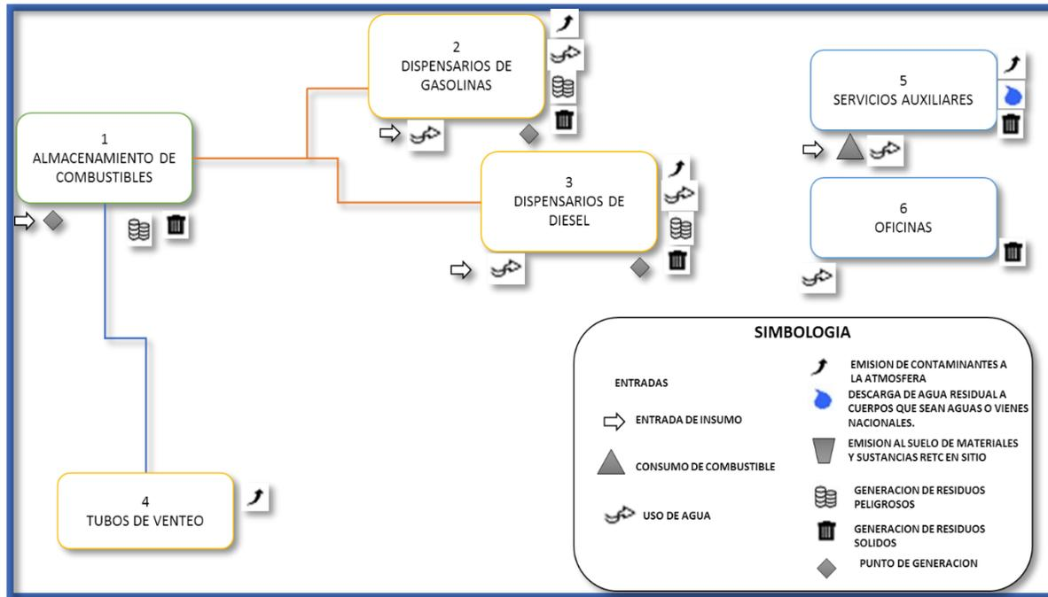
**Figura 6. Diagrama de funcionamiento general de la Estación de Servicio.**
