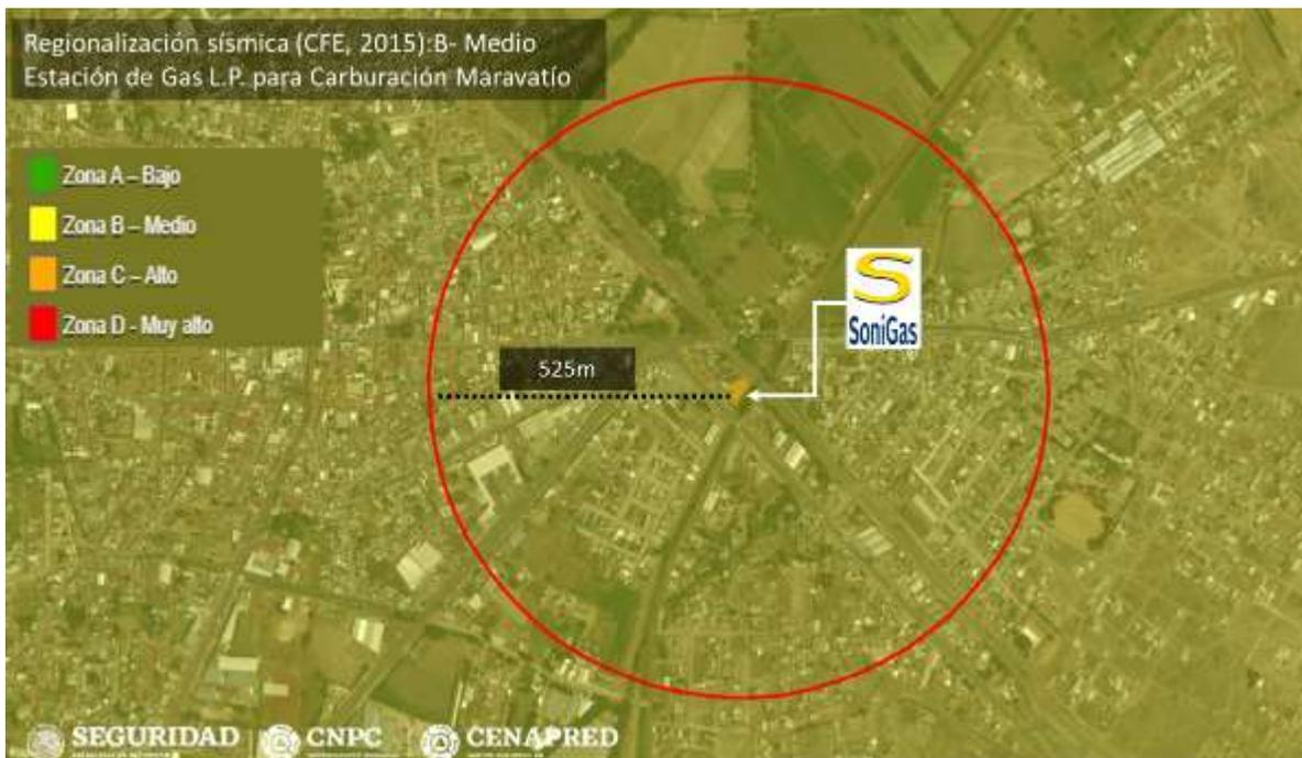
Figura 22. Regionalización sísmica del AI y área del proyecto, ubicadas en la Zona B de riesgo medio de presencia de sismos.
