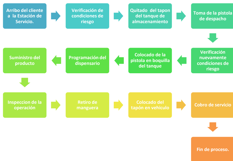
Figura 3.7: Diagrama con los puntos esenciales del procedimiento de despacho de producto al público consumidor.
