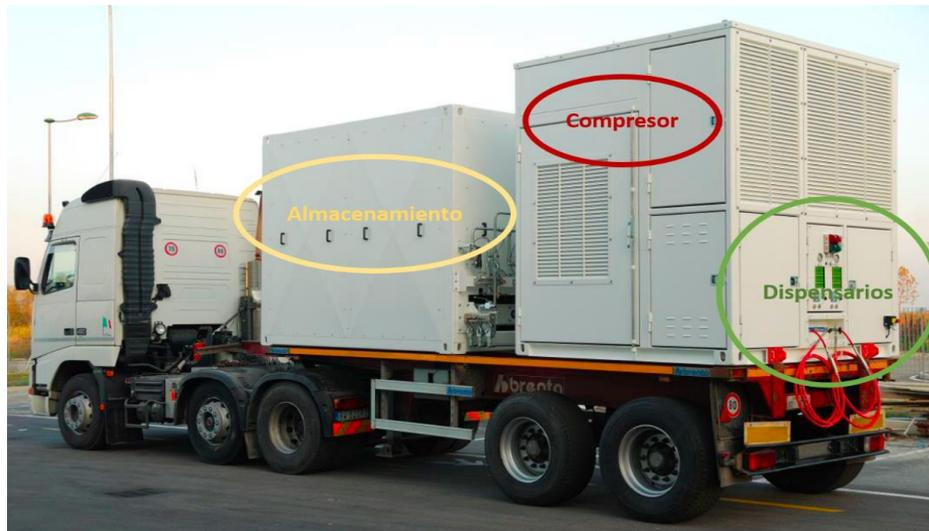
**Imagen II. 4 Equipo compuesto por la MRU.**
