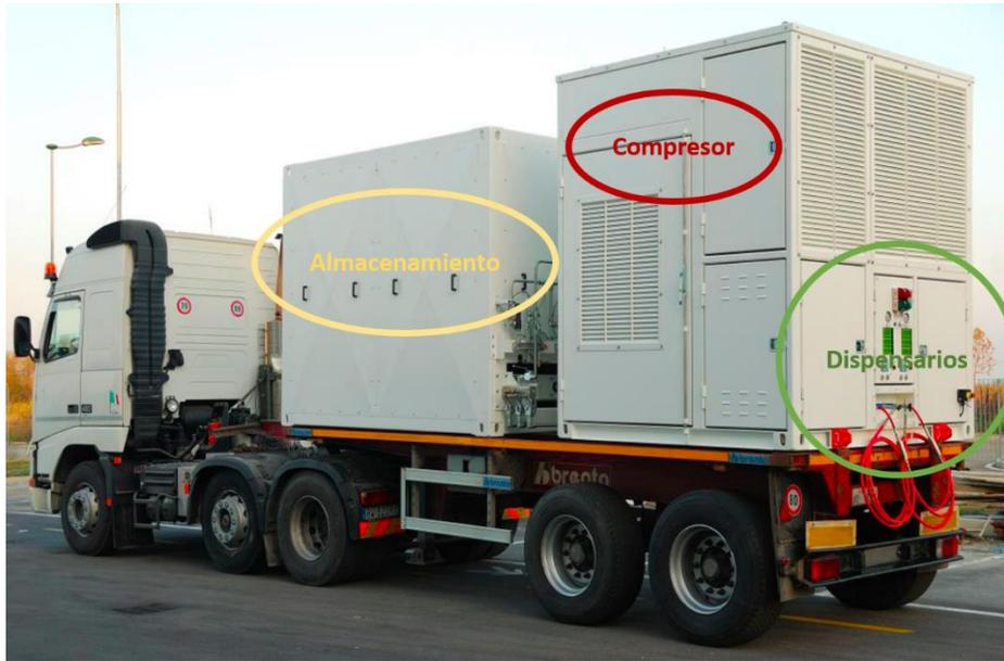
**Imagen II. 4 Equipo compuesto por la UMD.**
