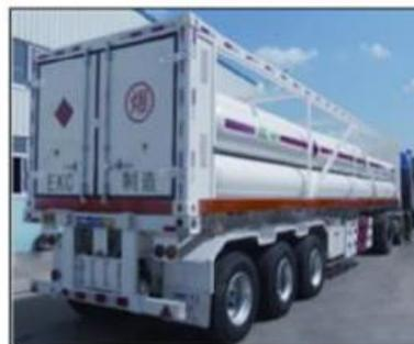
Ilustración 7. Módulo móvil de transporte, Skid 40 FT con cilindros Tipo 1-ISO 11120.
