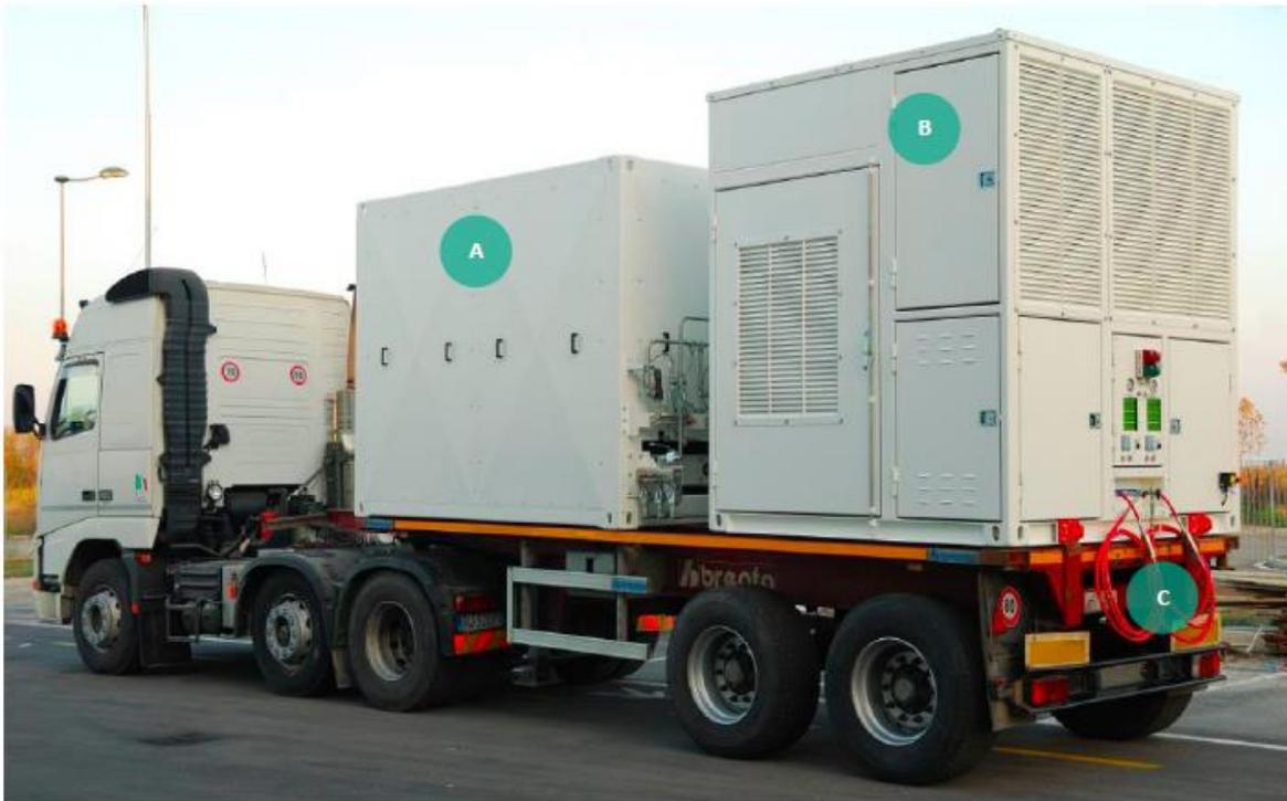
Ilustración 5. UMD. A Tanque de almacenamiento de GNV. B Equipo de compresión de GNV, C. Mangueras de descarga de GNV
