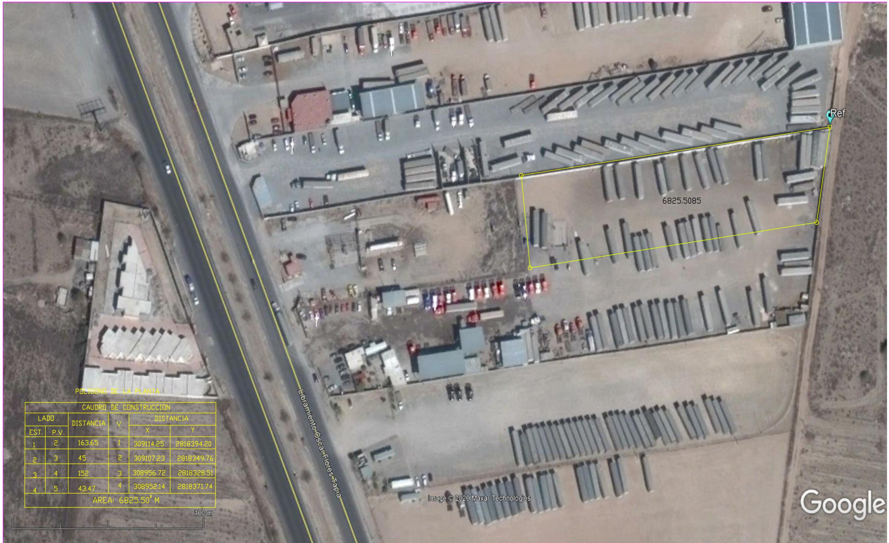
Figura 2\_b. Foto mapa de Google Earth con plano georreferenciado en autoCAD y delimitación del polígono para la planta de almacenamiento y distribución de gas L.P., identificando un radio de influencia de 1000 metros.
