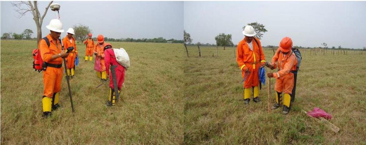
**Figura II.7.** Ejemplo de balizado de líneas fuentes o receptoras para el levantamiento sismológico 3D en zonas de potreros o praderas.
