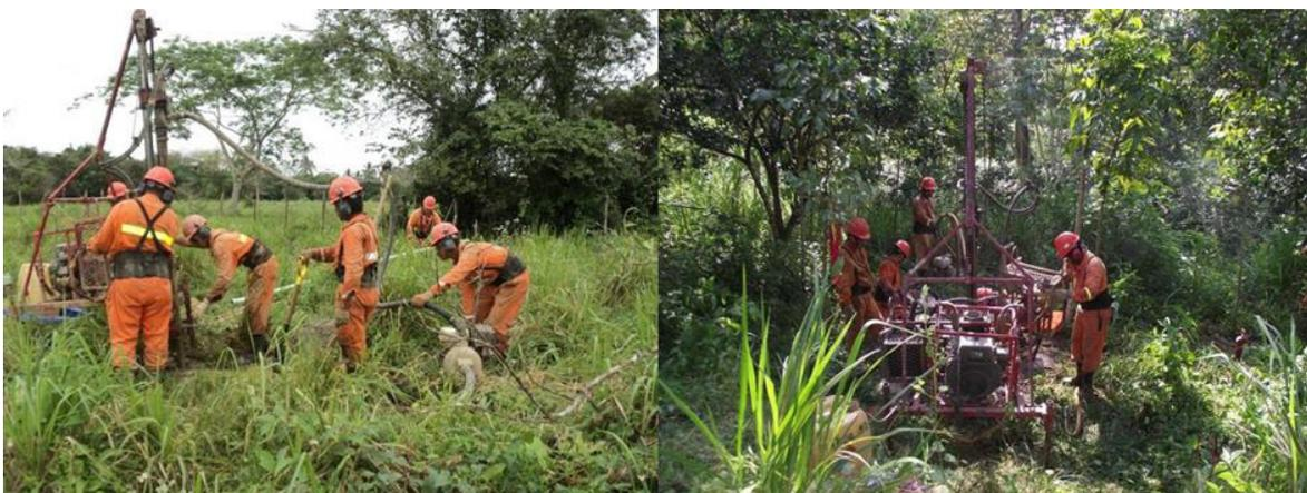
**Figura II.9.** Ejemplo de actividades de perforación de los puntos de tiro.
