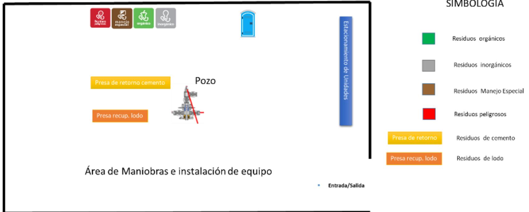
Figura III.3-10.- Lay Out de la ubicación del área de almacenamiento temporal de los residuos.
